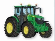
Breite: 266 cm: Länge: 581 cm (mit Frontkraftheber); Höhe: 323 cm
