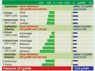
Messwerte vom Rollenprüfstand: Unten links steht der Powermix-Wert in g/kWh als Mittel aller 7 gemessenen Zyklen. Die Mittelwerte bei "Zugarbeiten", "Zapfwellenarbeiten" und "Gemischte Arbeiten" sind mit dem Dieselverbrauch in Gramm pro Kilowatt und Stunde und in Litern pro Hektar in roter
